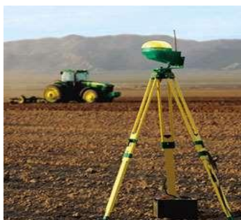
Figuras 1 e 2: Comunicação por satélites gerando sinais diferenciais de correção. Fonte: John Deere.
