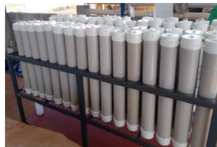
Figura 2. Colunas de lixiviação preparadas para receber o solo e prontas para condução do experimento.
