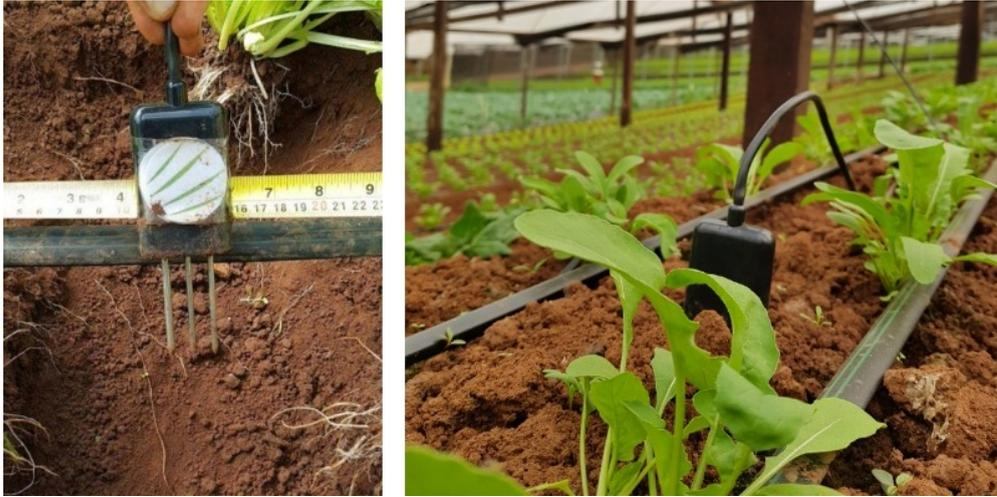
**Exemplo de sensor de temperatura e umidade do solo**
