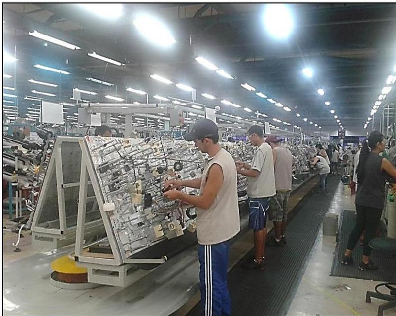
O Body Clip é um equipamento que testa a presença de componentes através do programa inserido no analisador e agulhas de presença.
