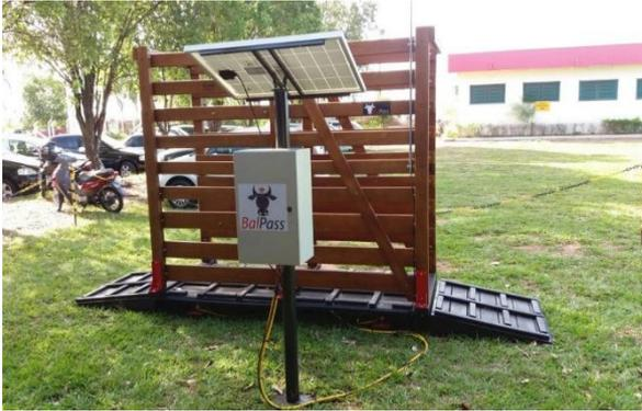
Fig. 2. Balança móvel movida a energia solar. Fonte: Embrapa.
