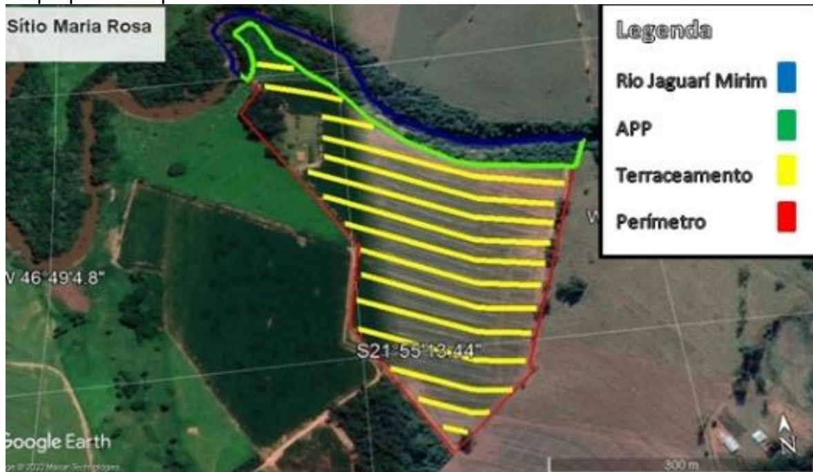
Figura 7: imagem indicando em linhas amarelas as curvas de nível que foram feitas na propriedade para evitar a erosão hídrica
