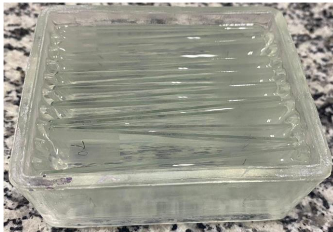
FIGURA 12. Lâminas inseridas em cuba de vidro para banhos de álcool, xilol e coloração
