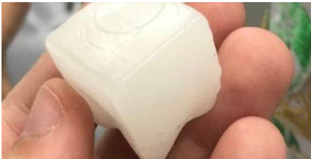
FIGURA 3. Bloco de parafina antes da lapidação
