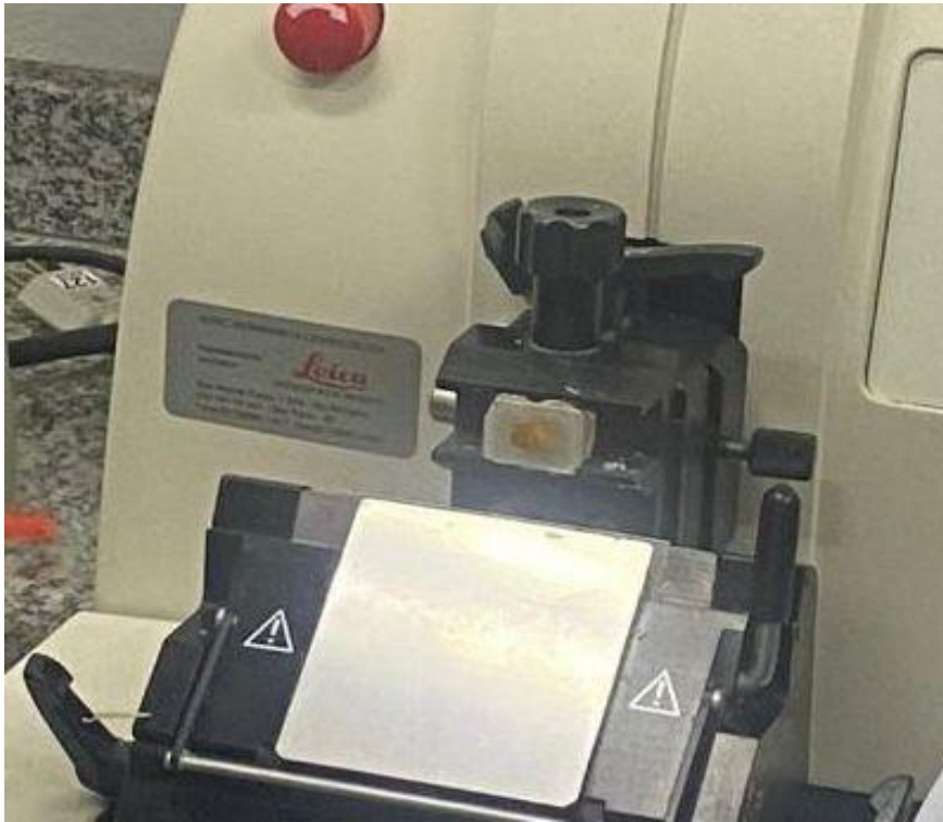
FIGURA 4. Bloco de parafina posicionado no micrótomo
