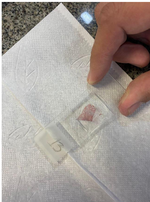
FIGURA 18. Lâmina de tricrômo masson finalizada observação a olho nu
