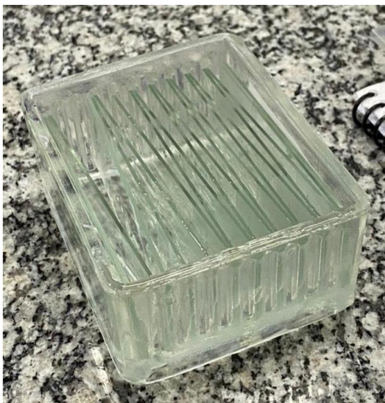
FIGURA 14. Lâminas inseridas em cuba de vidro para banhos de álcool, xilol e coloração.
