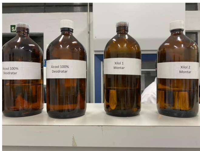
FIGURA 18. Baterias de soluções de álcool 100% para desidratar, e xilol 1 e xilol 2 para clarificação e montagem da lâmina.
