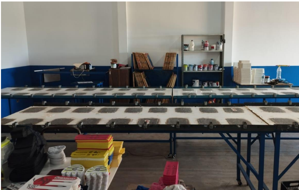
FIGURA 2 - Mesas utilizadas para modelagem e processo silk screen, ferramentas utilizadas no processo armazenadas ao fundo.
