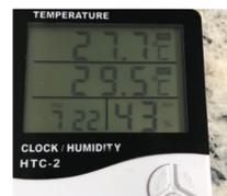
Figura 3 – Termohigrômetro
