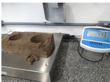
O próximo passo foi o teste de compressão para sabermos a resistência deste, a amostra dividida no meio, com uma área de  $217,5\text{cm}^2$ , dentro de um período de 3 minutos desde a retirada da água até a colocação na máquina de compressão para início de testes, suportando uma carga máxima de 3,06 toneladas ou  $0,135\text{KN}$  por  $\text{cm}^2$ .
