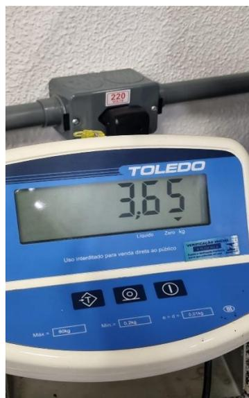
Após esse período submergimos o tijolo em água pelo período de 24 horas para fazermos o teste de absorção de água, pesamos o protótipo novamente chegando ao peso de 4,43kg, a absorção foi de 780g de água.
