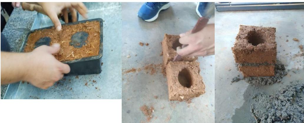
Com medidas de 15,0cm em um dos lados, 15,3cm no centro e 15,0cm no outro lado, após mergulhar na água fizemos o teste de absorção por um período de 15 minutos passamos para o teste de compressão e verificamos que o corpo de prova suportou a uma carga de 1,56 toneladas em uma área de 229,5 cm<sup>2</sup>, sendo equivalente a 0,067kn por cm<sup>2</sup>.
