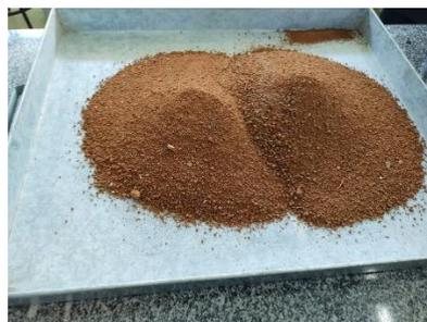
Primeiro passo: peneirar o solo para saber suas características conforme a granulometria, sendo utilizadas as peneiras com medidas 2,36mm, 1,18mm, 0,45 mm e 0,02 mm, sendo as duas primeiras consideradas arenosos, a segunda silte e a última como sendo argiloso.
