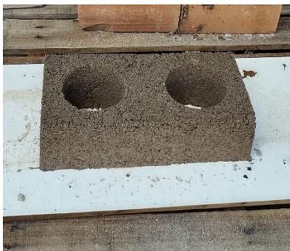
Fizemos medidas em três pontos diferentes de uma lateral a outra tivemos medidas diferentes de um lado 15cm, no centro 14,7cm e no outro lado 14,5cm, em seguida pesamos o tijolo seco obtivemos o peso de 3,65kg para ser feito o teste seguinte de absorção de água.
