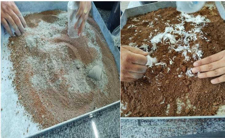
Após feita a mistura foi feito teste para sabermos a umidade adequada da mistura, pegamos cerca de 200g e prensamos com a mão, quando esta mistura ficou com desenho dos dedos soltamos de uma altura aproximada de um metro no chão e notamos que ela não se desmanchou totalmente, apenas uma pequena parte se desagregou, a partir daí colocamos a mistura na forma e após prensada desenformamos, ficando um período de cura de aproximadamente 7 dias.
