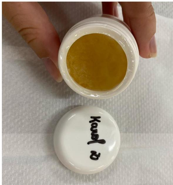
O último procedimento experimental deu origem a um produto viscoso que não possuía características semelhantes a de um sérum como demonstrado na Figura 4, isso porque foi utilizado uma quantidade de 1 grama de carboximetilcelulose, no entanto o aquecimento continuou sendo feito por meio de um agitador magnético com aquecimento, porém, o mesmo apresentou oscilações de temperaturas e agitação, o que também pode vir a justificar as características indesejadas que o produto apresentou.
