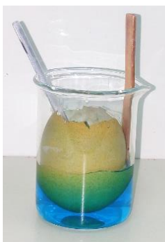
Figura 1. Pilha montada em casca de ovo. (Fonte: Imagem dos autores).
