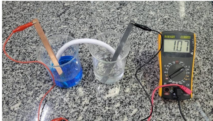
FIGURA 1. Realização do experimento de química Pilha de Daniell.
