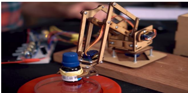
FIGURA 2. Braço Robótico com esqueleto de MDF. FONTE: https://youtu.be/Ecw3kCo4AdQ
