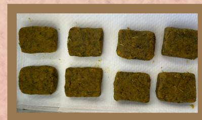
Figura 6: amostra do terceiro protótipo após 5 horas na estufa.
