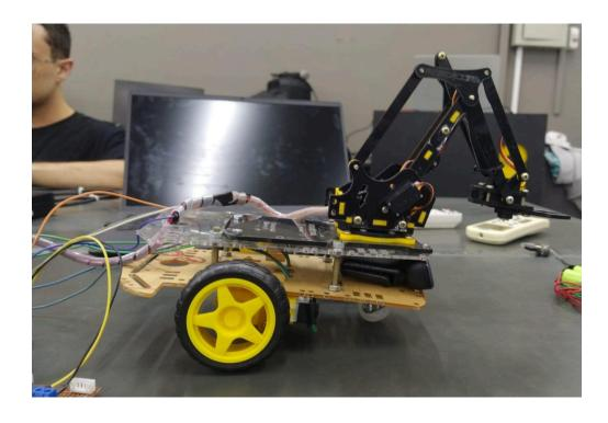
Além da mobilidade, o braço robótico é um elemento fundamental no desempenho do RoboSort 360. Equipado com uma pinça, ele possui quatro juntas articuladas que garantem ampla liberdade de movimento, permitindo a coleta de objetos em diferentes posições e
